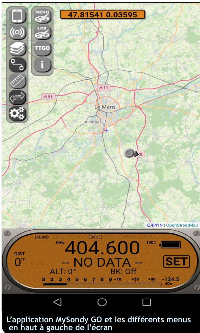
L'interface est très ergonomique. Le bouton SET sert à choisir la fréquence de réception et le modèle de radiosonde. J'ai placé une radiosonde M10 dans le jardin pour faire des essais. Le décodage est immédiat.
