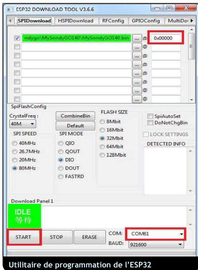
En cas de difficulté pour programmer le firmware sous Windows, relier un fil entre la masse (GND) et la broche GPIO0. Cela « force » le mode programmation. Sous Linux, ce fil est inutile en utilisant l'utilitaire en ligne de commande esptool (7) et les lignes de commandes suivantes :
