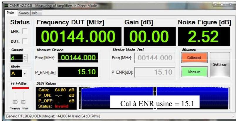
Mesure DUT : LNA Hartwig à PGA103+
